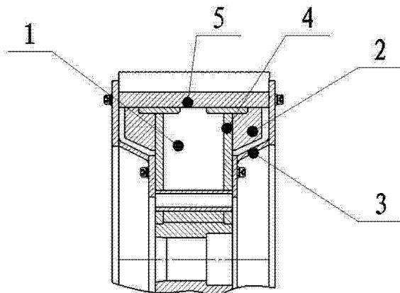
1. 一种多绳金刚石串珠锯驱动轮,其特征在于:在驱动轮(1)的加强筋板(2)的外侧覆盖有一圈密闭的封板(3),封板(3)的一端固定在内轮毂(4)上,另一端固定在外轮圈(5)上。
